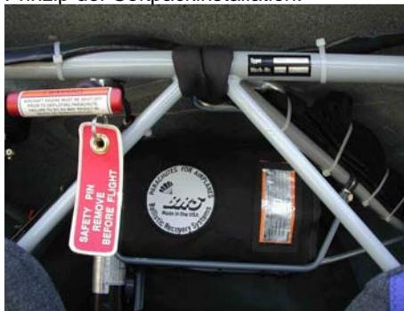
Das Rettungssystem (Softpack- und Containersystem) wird über einen roten Auslösegriff im Deckenbereich über den Piloten aktiviert. Der Sicherungsstift **muß** für den Flug entfernt werden. Um ein versehentliches Auslösen des Rettungssystems am Boden zu verhindern, sollte er bei der Hangarierung wieder eingesetzt werden.
