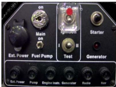
Bei Flugzeugen mit SMART Antrieb muss unverzüglich gelandet werden, weil der Motor eine Batteriezündung besitzt und stehen bleibt, sobald die Batterie leer ist.
