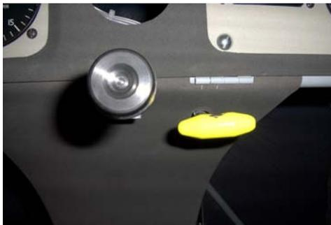
Zum Abstieg kann entsprechend den Temperaturverhältnissen die Kühlluftklappe ganz oder teilweise geschlossen werden.
